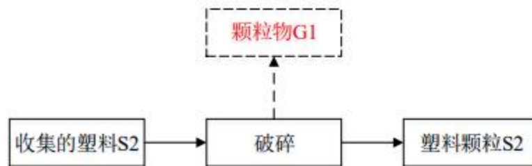
图 2-14 塑料破碎线工艺流程及产污环节图
